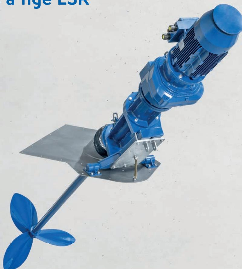
L'agitateur à tige ESR 204 est équipé d'un moteur électrique de 15 kW (homologué pour la protection EX, zone 2) et assure, grâce à un régime max. de 100 tr/min et à une hélice d'un diamètre de 140 cm, une poussée optimale et un résultat de brassage maximal dans les installations de biogaz.
