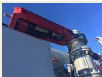
DÉBITMÈTRE POUR DPA AVEC VANNE ÉLECTRIQUE DE RÉGLAGE DU DÉBIT
