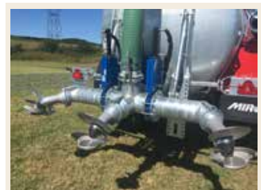
TRIPLE BUSES DE PRÉCISION AVEC VANNES POUR SÉPARATION DE TRONÇONS
