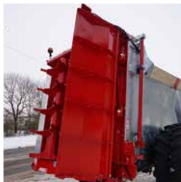
VOLET DE BORDURE PERMETTANT DE LIMITER LA LARGEUR DE TRAVAIL (BORD DE CHAMP, ...).
