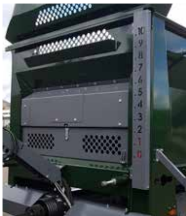
INDICATEUR D'OUVERTURE DE PORTE MÉCANIQUE OU ÉLECTRONIQUE
