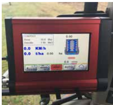
BOITIER DPA PERMETTANT LA COMMANDE DE TOUTES LES FONCTIONS HYDRAULIQUES ET LA GESTION DU DÉBIT DE L'ÉPANDEUR.
