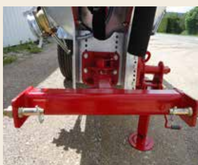
ATTELAGE À LA BARRE DE RELEVAGE 3 POINTS (gamme MTV uniquement)
