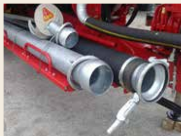
RANGE TUYAUX SOUS LA CUVE
