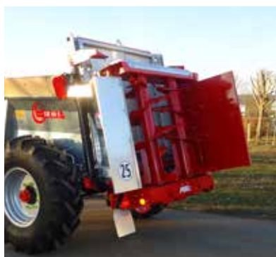
VOILET DE BORDURE PERMETTANT DE LIMITER LA LARGEUR DE TRAVAIL (BORD DE CHAMP, ...).
