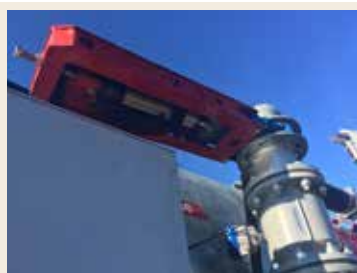
DÉBITMÈTRE POUR DPA AVEC VANNE ÉLECTRIQUE DE RÉGLAGE DU DÉBIT
