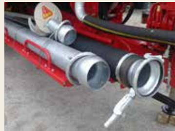
RANGE TUYAUX SOUS LA CUVE
