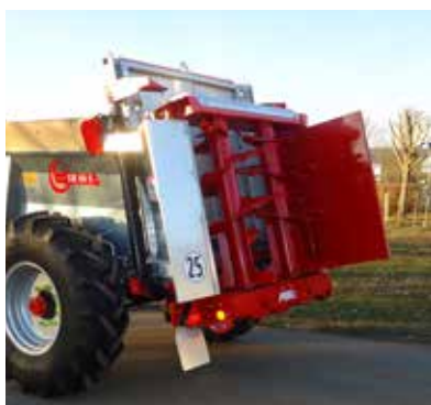
VOLET DE BORDURE PERMETTANT DE LIMITER LA LARGEUR DE TRAVAIL (BORD DE CHAMP, ...).
