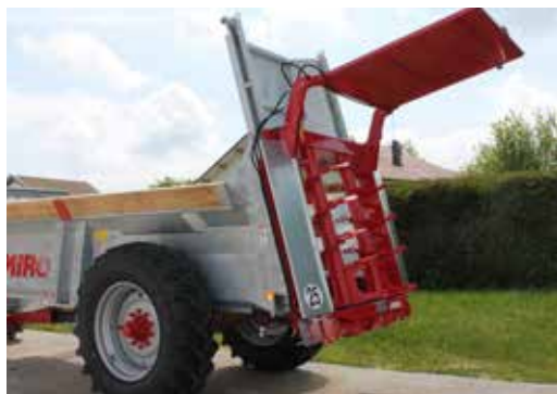
PROTECTION DES HÉRISSEONS POUR LA CIRCULATION DES MACHINES SUR LA ROUTE. (SURTOUT UTILISÉ EN SUISSE)
